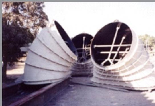
Tubo de Sucção - Usina Hidrelétrica
